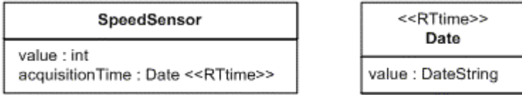
Figure 16.1. Example of usage of the stereotype «RTtime»
